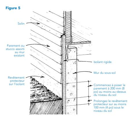
On peut tenir les panneaux de contreplaqué ou de ciment en place à l'aide d'attaches pour isolant. Les bords coupés des panneaux de contreplaqué devraient être placés au-dessus du niveau du sol (si possible). Lorsque les bords coupés sont placés sous le niveau du sol, on devrait y appliquer un produit de préservation à l'aide d'une brosse.
