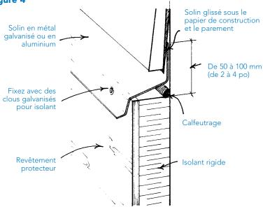
Bien que chaque cas soit unique, il est souvent plus facile de glisser le solin sous le parement existant (ou le stucco) et le papier de construction *avant* de poser l'isolant sur le mur. Une fois que la pose de l'isolant et du revêtement est terminée, vous pouvez baisser légèrement le solin et le fixer avec des clous galvanisés à chaud.
