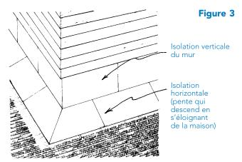
La meilleure méthode consiste à utiliser des attaches spéciales pour isolants. Ces attaches sont habituellement constituées de clous galvanisés à chaud munis de grandes rondelles de retenue. Si les clous doivent être enfoncés dans du béton ou de la pierre plutôt que dans du bois, il vous faudra probablement percer des trous-guides ou utiliser un outil électrique. Demandez l'avis de votre fournisseur de matériaux de construction.
