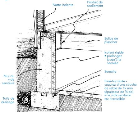
Si le vide sanitaire est tellement humide (même lorsque son plancher est recouvert d'un pare-humidité) qu'il faut l'aérer été comme hiver, vous devriez choisir le vide sanitaire non chauffé. Dans la plupart des autres cas, il est recommandé d'isoler, de préférence de l'extérieur, les murs du vide sanitaire pour obtenir un espace chauffé pour les raisons suivantes :
