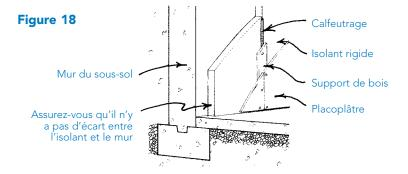
Cette méthode donne une installation qui occupe moins d'espace que l'ossature en bois et est plus rapide à exécuter. Cependant, elle est coûteuse et ne peut être adoptée que si les murs sont lisses, et sans problèmes d'humidité. Le câblage électrique devient aussi plus difficile à loger.
