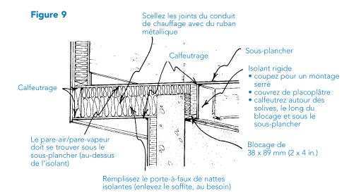
Vous pouvez aussi demander à un entrepreneur d'insuffler de l'isolant par des trous percés dans la face inférieure du porte-à-faux ou couvrir d'isolant rigide la face inférieure du porte-à-faux.
