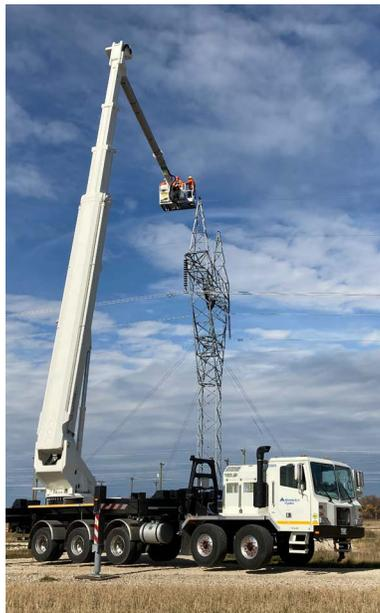
« Le nouvel équipement aérien aide à réparer les lignes de transport de courant continu à haute tension comme nos lignes Bipolaire I, II et III. Il peut s'allonger sur 60 mètres (200 pieds), donc ça réduit notre besoin de procéder à des interruptions coûteuses pour effectuer des réparations », a expliqué Jeffrey Laninga, Entretien des lignes de transmission chez Manitoba Hydro. « Une interruption planifiée d'une ligne Bipolaire peut coûter environ 400 000 \$ par jour ».
